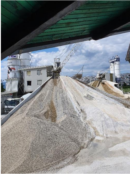
Skladištenje agregata u boks u obliku zvijezde
